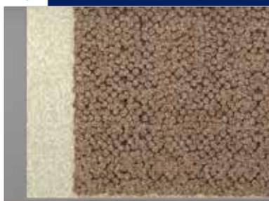
Protections Adhérentes, appliquées in situ, formant après séchage une protection totalement solidaire de la membrane d'étanchéité **MARISEAL®**:
